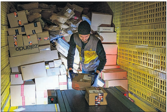
Un employé alimente le tapis roulant en continu, geste qui assure le flux constant des colis vers les différentes étapes du tri automatisé
