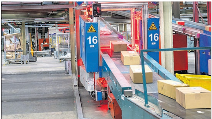
Sur la vingtaine de lignes de déchargement, chaque colis franchit un scanner qui en mesure ses dimensions et examine l'adresse avant d'être dirigé vers sa destination
