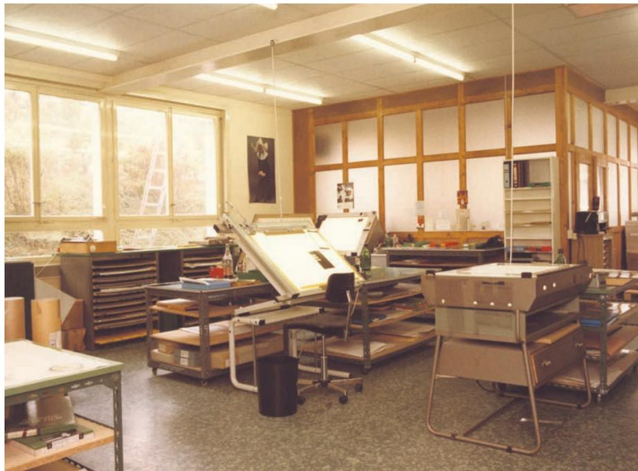
Les tables lumineuses, outils essentiels des imprimeries traditionnelles. Elles permettent aux typographes de vérifier l'alignement, la disposition et la lisibilité des textes ou des images en transparence, avant l'impression finale
