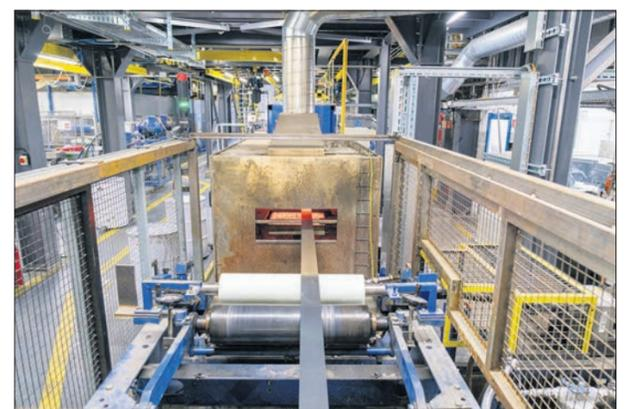
Le passage à haute température (240°) permet d'ancrer durablement la peinture tout en captant les solvants pour éviter leur dispersion dans l'atmosphère
