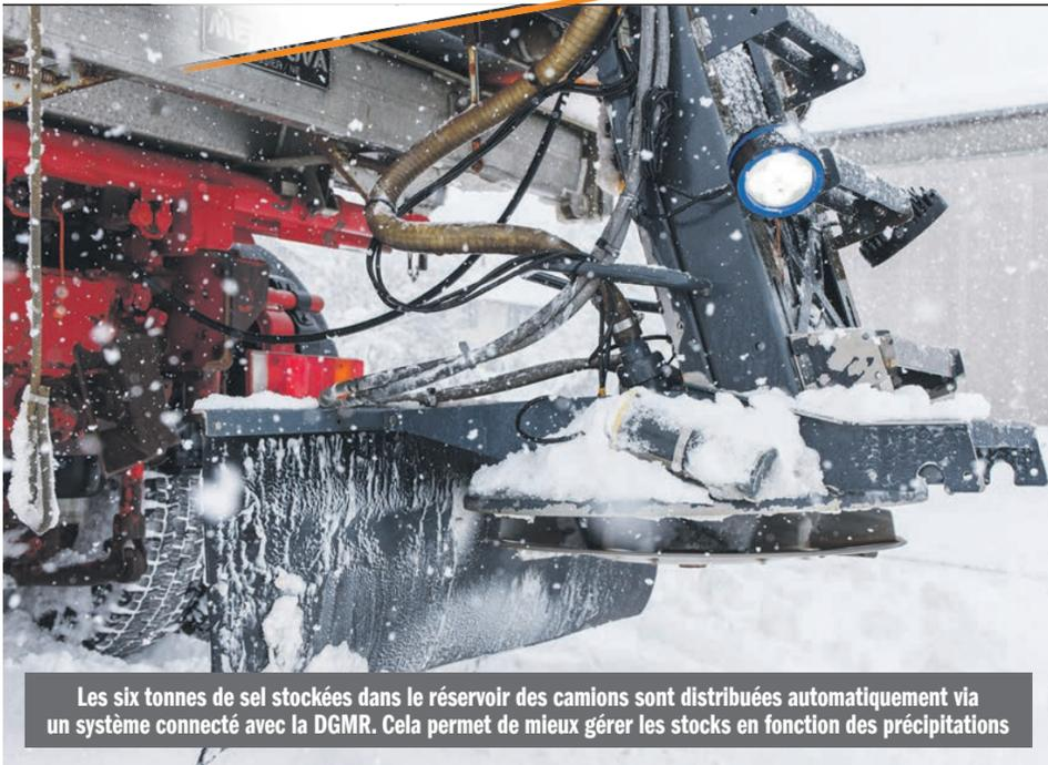
Les six tonnes de sel stockées dans le réservoir des camions sont distribuées automatiquement via un système connecté avec la DGMR. Cela permet de mieux gérer les stocks en fonction des précipitations
